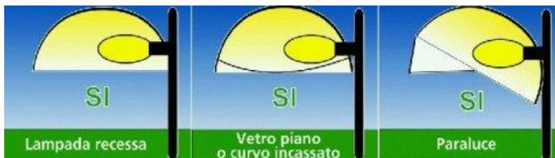
Figura 7. Tipologie di apparecchi conformi alla L.R. n. 17/2009
