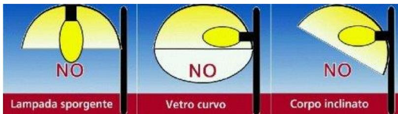
Figura 6. Tipologie di apparecchi non conformi alla L.R. n. 17/2009
